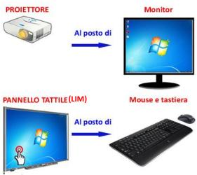
Nel sistema LIM II proiettore sostituisce il monitor mentre il pannello tattile sostituisce mouse e tastiera
