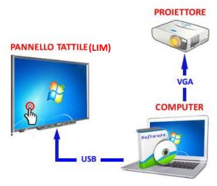
Il computer proietta le immagini sul pannello LIM tramite un proiettore; alcuni software applicativi installati nel computer permettono l'uso del pannello LIM in modo touch.
